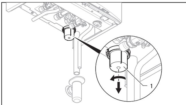
1. Снимите нижнюю часть сифона (1), повернув нижнюю часть против часовой стрелки.
