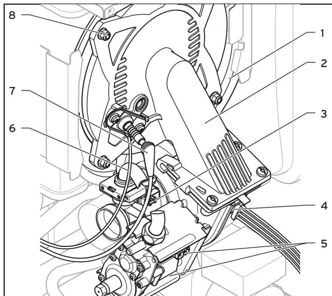
1. Наденьте компактный термомодуль (2) на теплообменник (1).
