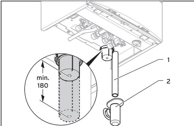
В результате сгорания топлива в изделии образуется конденсат. Линия отвода конденсата отводит конденсат через сливную воронку к присоединительному патрубку канализации.
