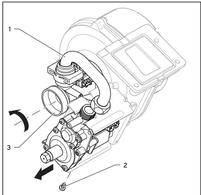
7. Извлеките весь узел, состоящий из вентилятора, устройства Вентури и газовой арматуры из изделия.
