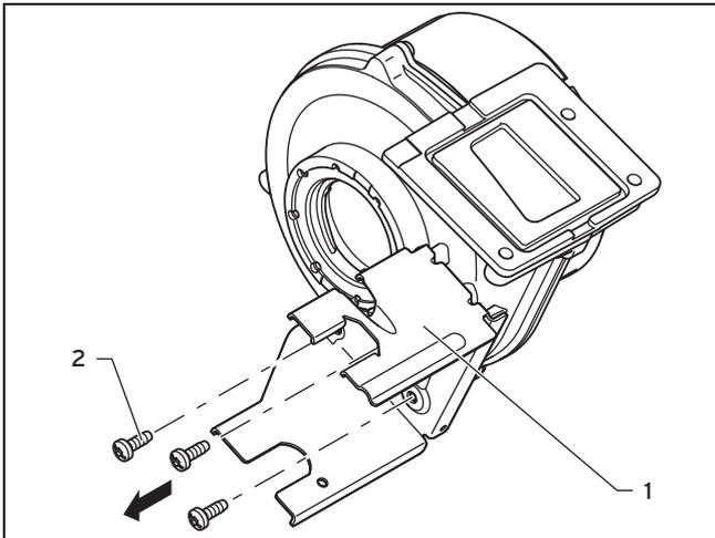
11. Демонтируйте держатель (1) газовой арматуры с держателя, выкрутив три винта (2).
