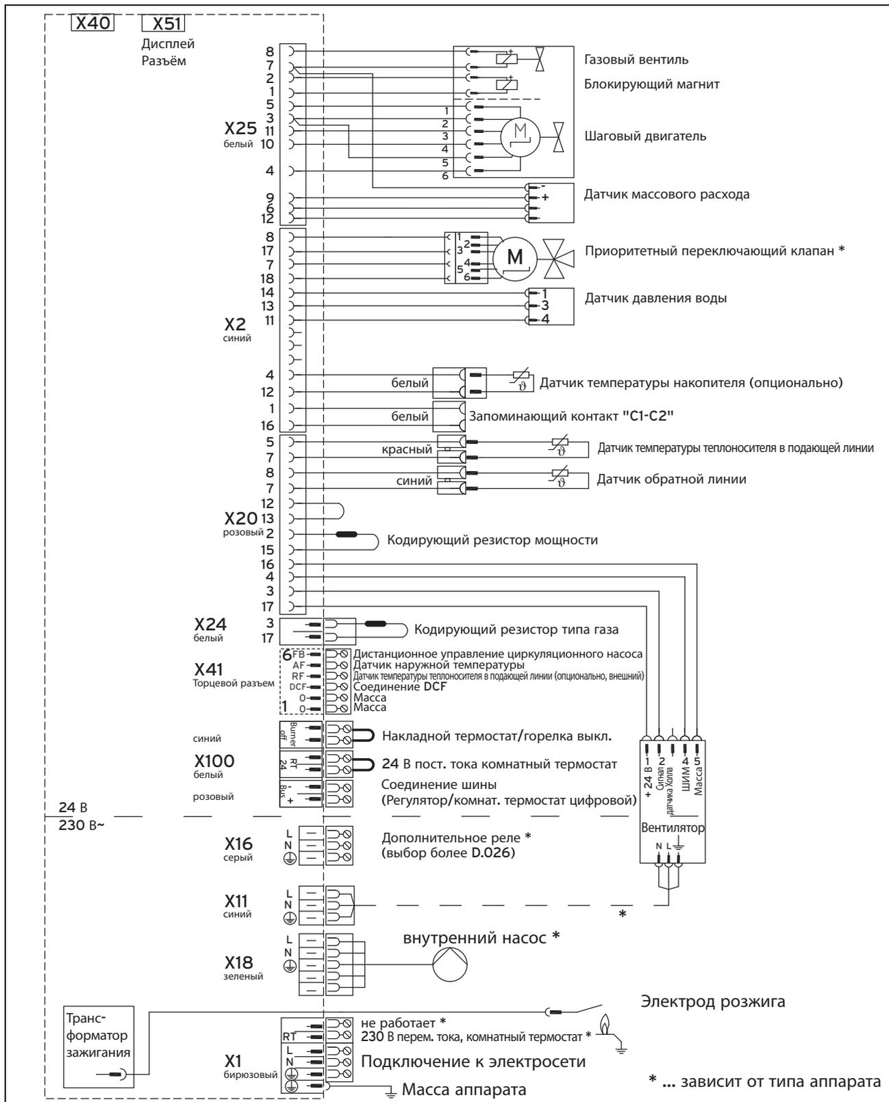
F.2 Схема электрических соединений VUW
