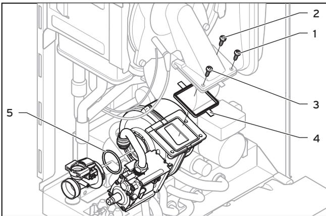
13. Выполните установку компонентов в обратной последовательности. Используйте при этом только новые уплотнения (4) и (5). Соблюдайте последовательность вкручивания трех винтов между вентилятором и трубой смеси в соответствии с нумерацией (1), (2) и (3).
