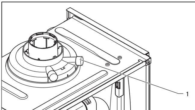
3. Измерьте содержание CO<sub>2</sub> на измерительном патрубке отходящих газов (1).
