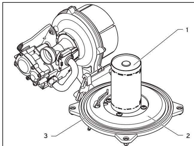
1. Проверьте поверхность горелки (1) на наличие повреждений. При обнаружении повреждений замените горелку.
