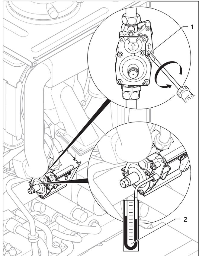
2. С помощью отвертки открутите уплотнительный винт измерительного штуцера (1) (нижний винт) на газовой арматуре.
