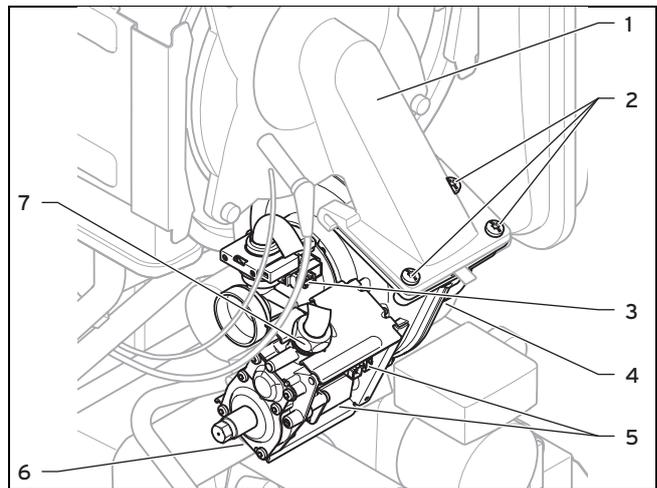
1. Снимите воздухозаборную трубу.
