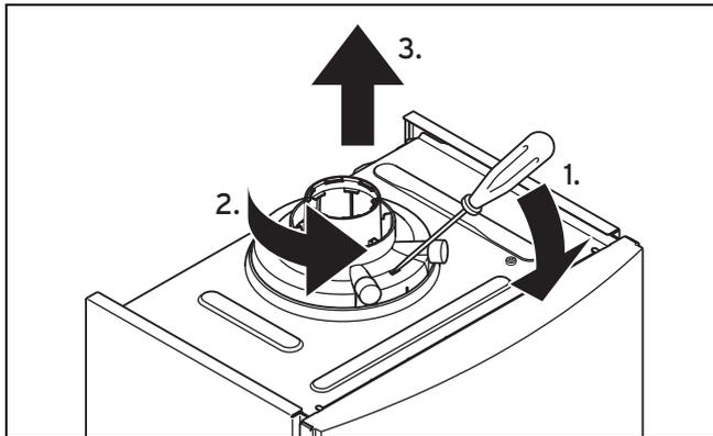
1. Вставьте отвертку в шлицевое отверстие между измерительными штангами.
