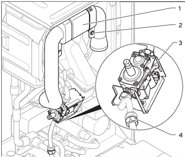
5. Выверните удерживающий винт (2) и снимите воздухозаборную трубу (1) со всасывающего штуцера.
