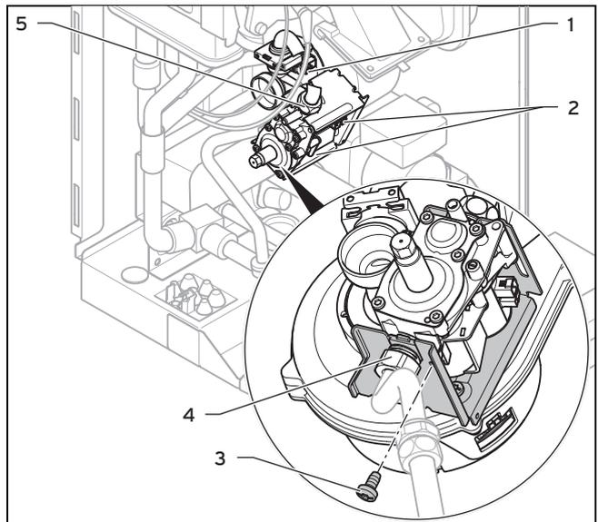
1. Снимите воздухозаборную трубу.
