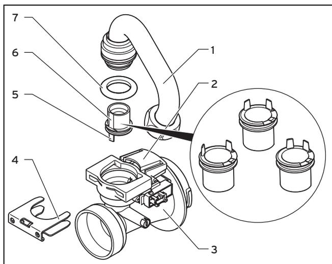
5. Демонтируйте газовую соединительную трубу (1) с устройства Вентури (3), сняв скобу (4) и вытащив газовую соединительную трубу вертикально. Утилизируйте уплотнение (7).
