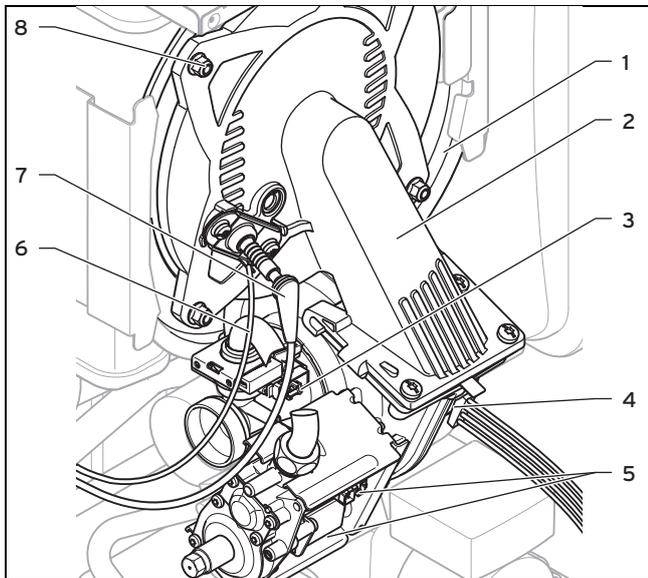
7. Отсоедините штекер провода розжига (7) и провода заземления (6) с электрода розжига.
