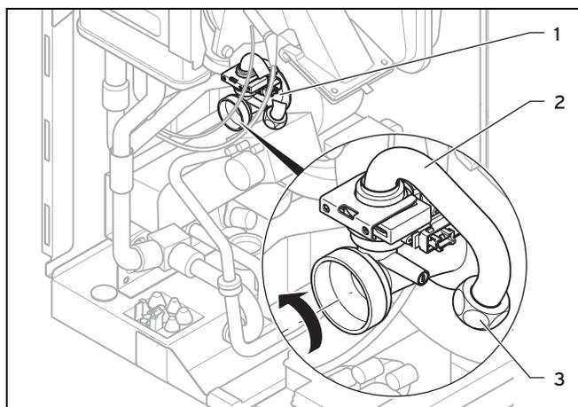
1. Снимите воздухозаборную трубу.
